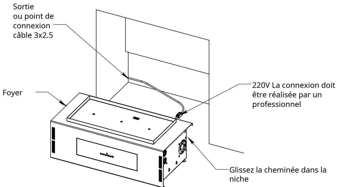
Il est obligatoire d'utiliser une ligne séparée avec un disjoncteur d'un calibre d'au moins 10A
