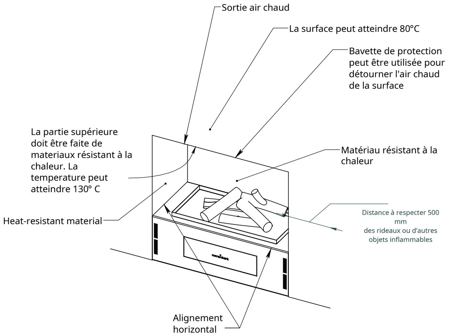
Pour une utilisation conforme de cette cheminée, il est nécessaire d'assurer l'apport d'air frais dans la pièce et une évacuation des gaz brûlés. Il peut s'agir d'une VMC, d'un récupérateur ou une fenêtre ouverte.
