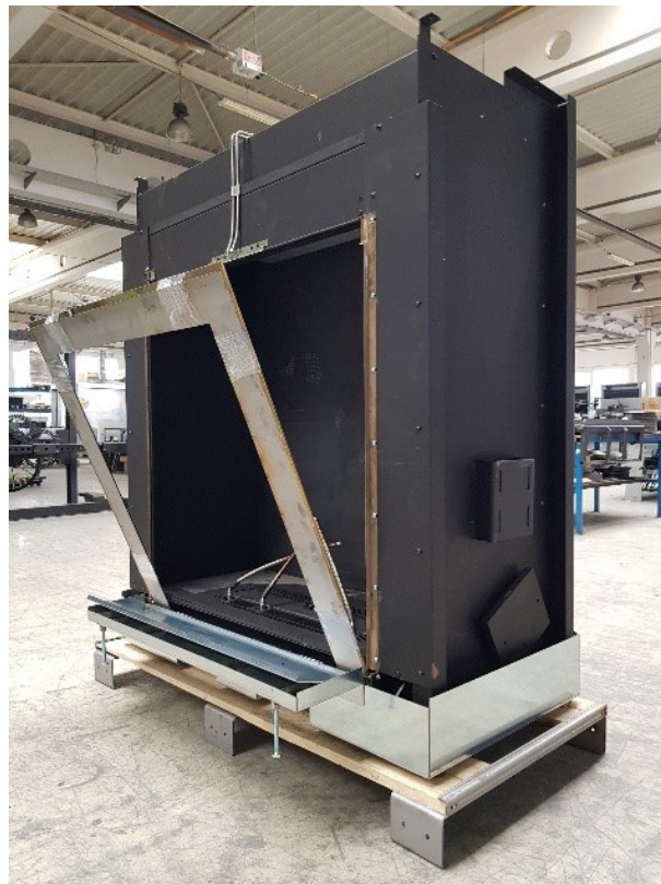
Porte entièrement ouverte : la tôle inclinable doit être inclinée comme sur la photo
