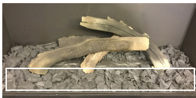
Déposer l'imitation charbon selon la photo
