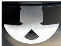
4: Secondaire et primaire ouverts (phase de mise à feu)
